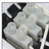
kostka przyłączeniowa dodatkowo odizolowana od obudowy
